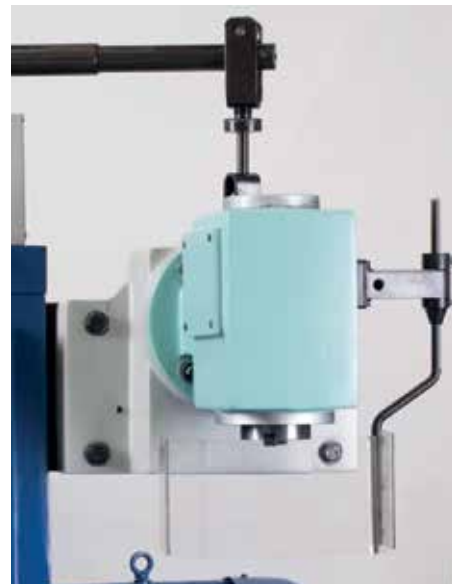
> CABEÇOTE VERTICAL COM SUPORTE ARTICULÁVEL INCORPORADO À MAQUINA
