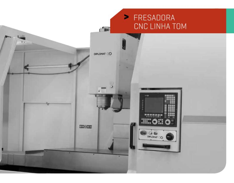
> FRESADORA CNC DE ALTA ROBUSTEZ COM 4 GUIAS DE APOIO NA MESA E EIXO ÁRVORE COM CONE BT50
