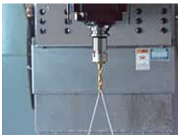
Sistema de refrigeração através do eixo-árvore
