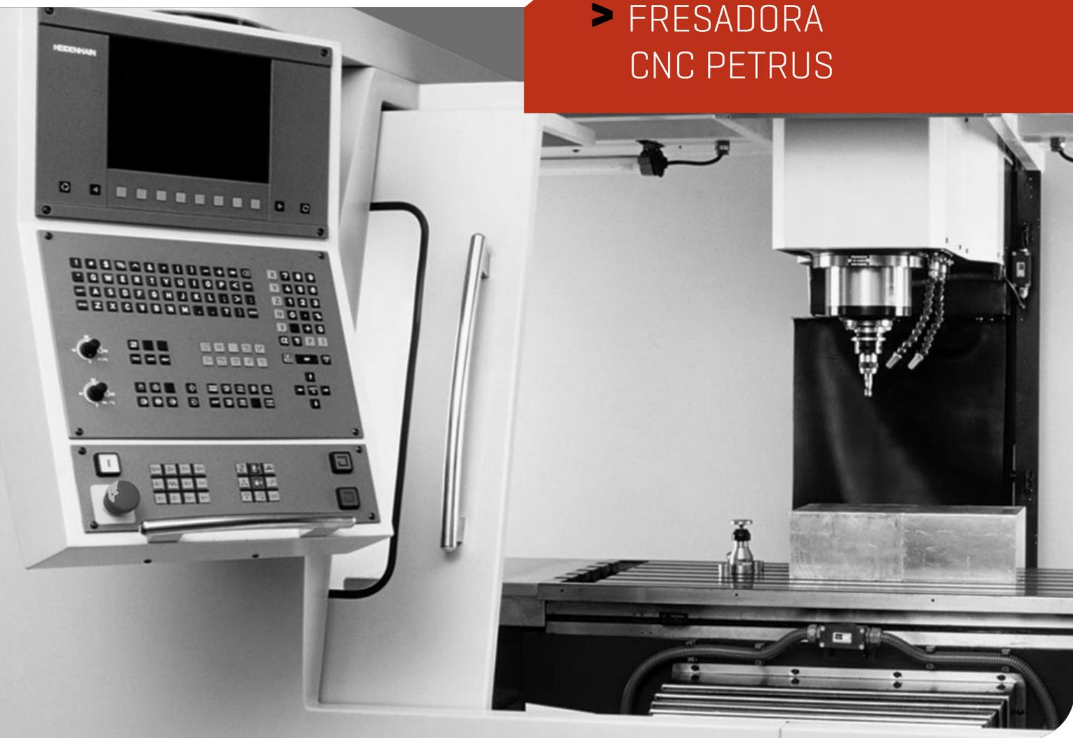
> LINHA DE FRESADORAS CNC DE BANCO FIXO COM EXCELENTE ESTABILIDADE, ROBUSTEZ E FLEXIBILIDADE.
