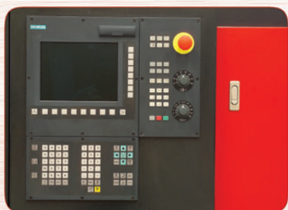
Comando SIEMENS 802Dsl
